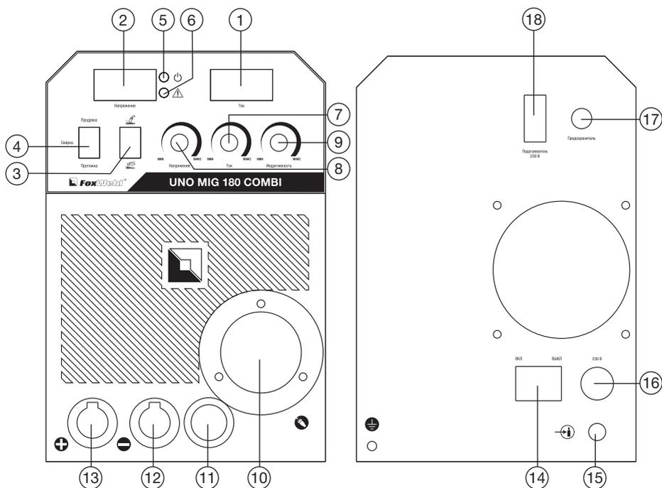
1. **Цифровой дисплей сварочного тока:** отображает значения только во время сварки. Дисплей работает в режиме амперметра.
