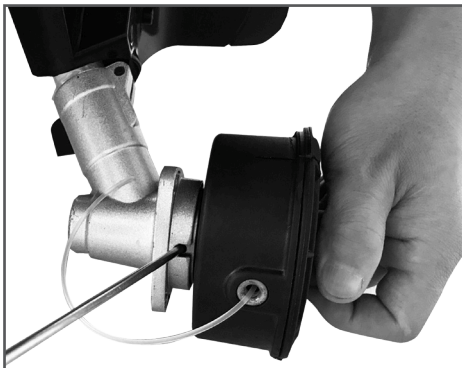
Рис. 10 Установка триммерной головки
