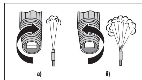
При необходимости обработки изделия или поверхности моющим средством, снимите крышку 4 бачка и, соблюдая рекомендованную производителем концентрацию, заправьте емкость моющим раствором. Установите струю низкого давления, нанесите моющее средство на обрабатываемую поверхность и оставьте подействовать на 1–2 минуты, не допуская его высыхания.
