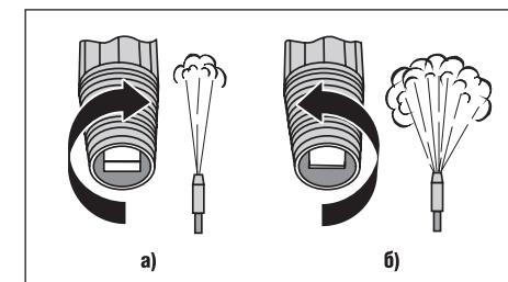
При необхідності обробки вироби або поверхні миючим засобом, зніміть кришку 4 бачка і, дотримуючи рекомендовану виробником концентрацію, заправте ємкість миючим розчином. Встановіть струмінь низького тиску, нанесіть миючий засіб на оброблювану поверхню і залишить подіяти на 1–2 хвилини, не допускаючи його висихання.
